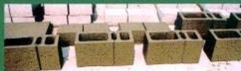
Frische Verschalungshohlblocksteine aus Recyclingbeton
